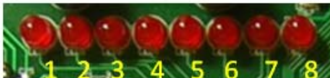
Obr. 8: Rozmístění LED diod na výukovém přípravku
