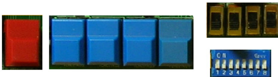
Obr. 10: Neošetřená tlačítka, ošetřená tlačítka, posuvné přepínače a DIP 08
